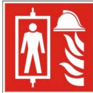
Abb. 5: Piktogramm für einen Feuerwehraufzug nach DIN EN 81-72, Anhang F.
