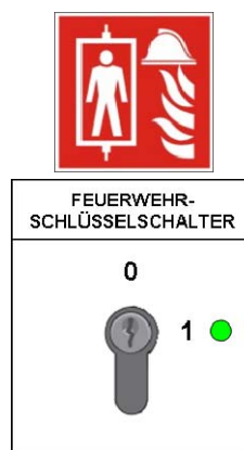
Abb. 3: Ausführung des Feuerwehr-Schlüsselschalters im Fahrkorb für Schließung Feuerwehr Stuttgart.
