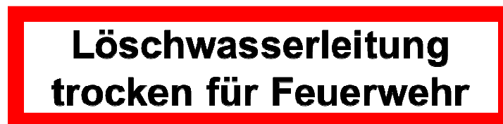
Abb. 11: Kennzeichnung der Entnahmestelle bei Löschwasseranlagen „trocken“.
